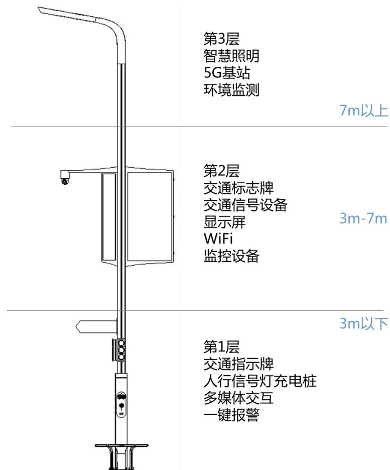
图 1 多功能信息杆柱塔三层设计示意图
